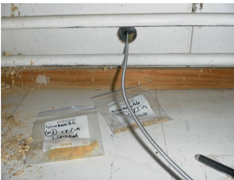
Kuva 5. Materiaalinäytteet N3 ja N4 otettiin ulkoseinärakenteesta satunnaisesti valitusta kohdasta. Näyte N3 otettiin lastulevyn takana olevasta 50 mm lasivillakerroksesta ja näyte N4 otettiin ulkopuolisen betoniseinän valumuottina olleesta Toja-levystä. Molemmissa näytteissä todettiin kohtalaista tai runsasta kosteusvauriota indikoivan ja mahdollisina toksiinien tuottajina pidettyjen aktinomykeettien (sädesienet) sekä homesienten kasvua. Näytteet osoittivat ulkoseinärakenteessa olevan selvästi viitearvot ylittävää mikrobikasvua.
